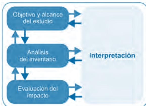
**Figura 12.** Esquema de un Análisis del Ciclo de Vida según la norma ISO 14040.
